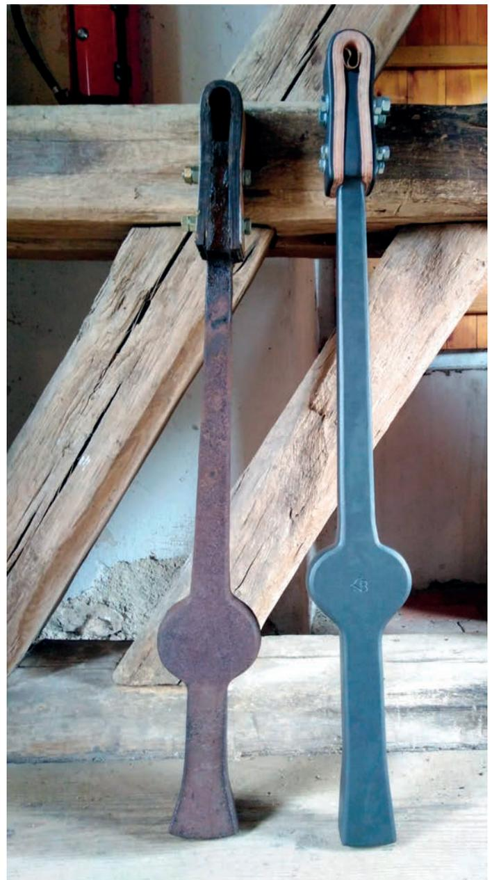
Staré srdce (vlevo) sloužilo od 28. září 1947 do 28. září 2021. Příliš tvrdé srdce historický zvon nadměrně vytloukalo. Nové srdce (vpravo) váží cca 37 kg, tvarově vychází z původního barokního.
